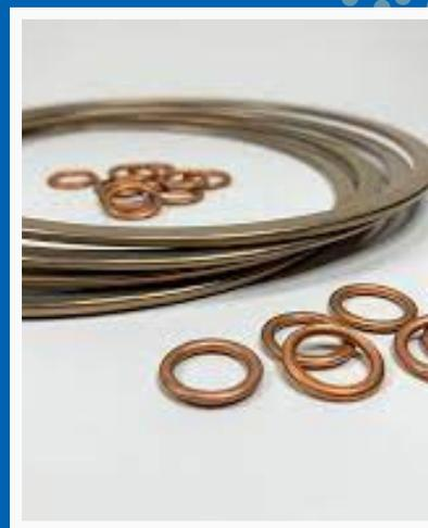
Les joints métaloplastiques sont constitués **d'une âme qui peut être en graphite, fibre céramique ou PTFE, recouverte d'une enveloppe métallique de fine épaisseur** généralement en cuivre, cupro-nickel, acier doux, monel, acier inoxydable (304L, 316L, 321...), inconel ou nickel. L'enveloppe métallique de ces joints est destinée à renforcer et à protéger l'âme en matériaux tendre des destructions mécaniques et chimiques.
