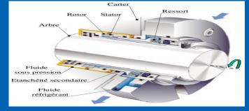
Une garniture mécanique de base comporte **trois points d'étanchéité** :
